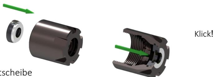
Abbildung 2: Montage der Dichtscheibe
