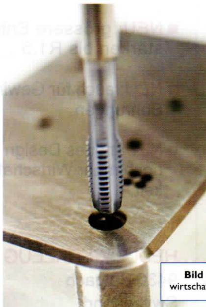
**Bild 2:** NORIS TWIN HT HM OSM aus VHM, für die wirtschaftliche Bearbeitung gehärteter Stähle bis 63 HRc
