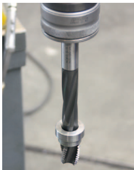
5 Der Nachfolger: Der schwachspiralgenutete Gewindebohrer von Reime sorgt dank Gefügestauchung für kurze Späne
